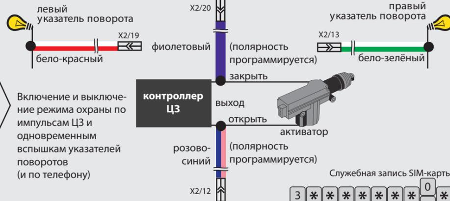
Включение и выключение режима охраны по импульсам ЦЗ и одновременным вспышкам указателей поворотов (и по телефону)
